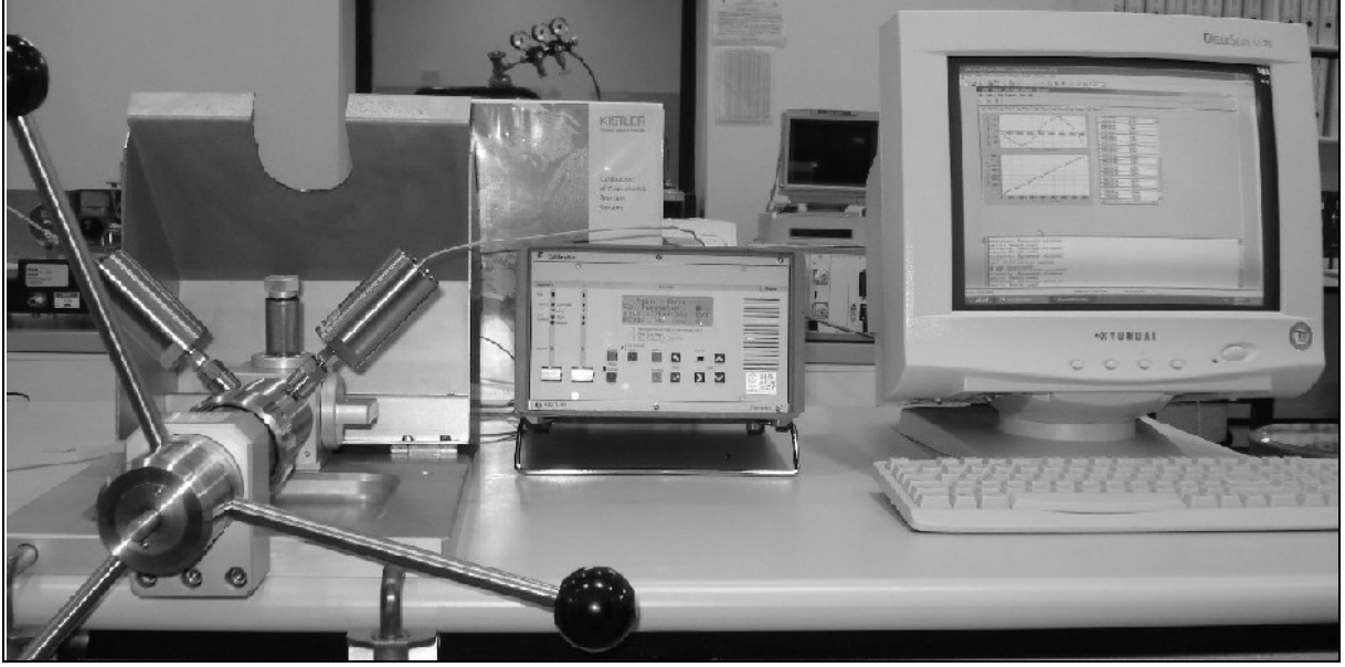
Şekil 1. UME dinamik basınç ölçüm sistemi kalibrasyon düzeneği [1].
