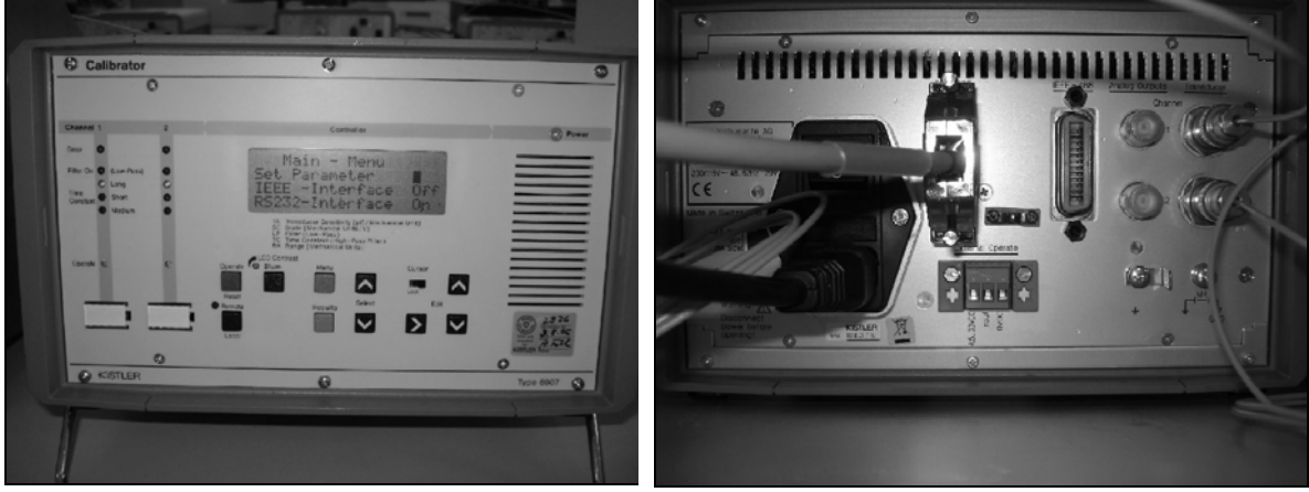
Şekil 5. Sinyal şartlandırıcı (kalibratör), önden ve arkadan görünüm [4].
