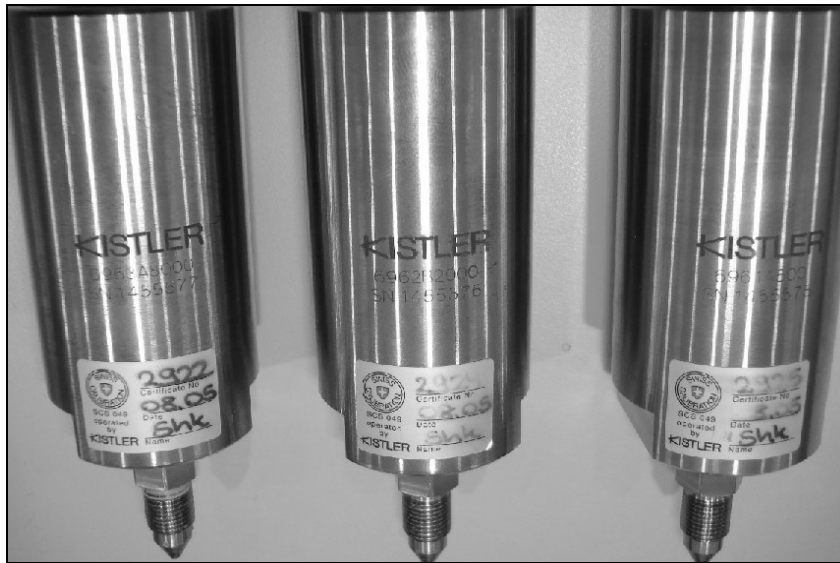
Şekil 4. Dinamik basınç dönüştürücüleri [3].
