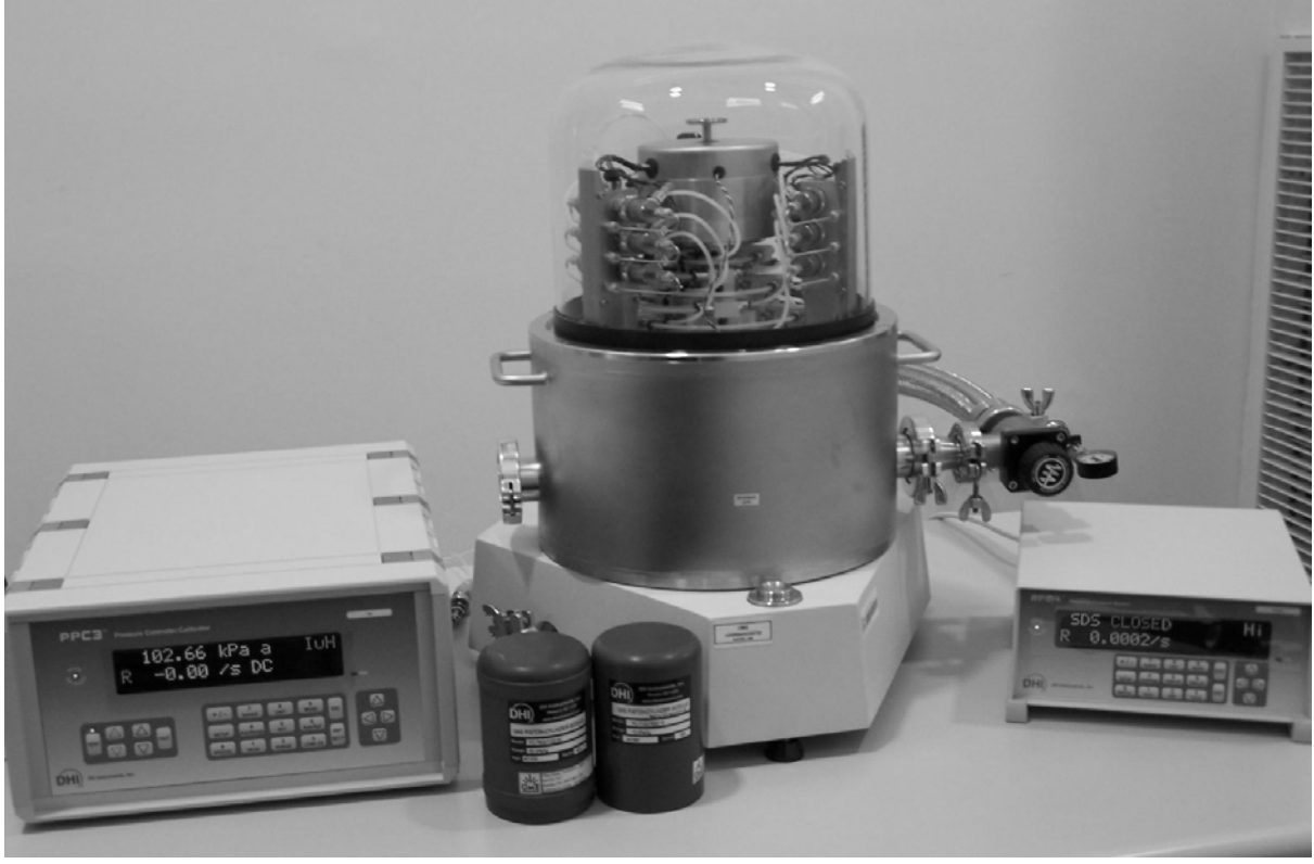
Şekil 1. UME tam otomatik kütle yüklemeli pistonlu basınç standardı
